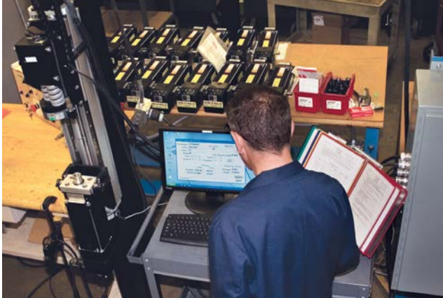
Prueba de funcionamiento de la unidad durante cientos de ciclos, cuantifica las carreras, la longitud, par bajo carga nula, entrada de corriente frente a la desviación de fuerza estándar.
